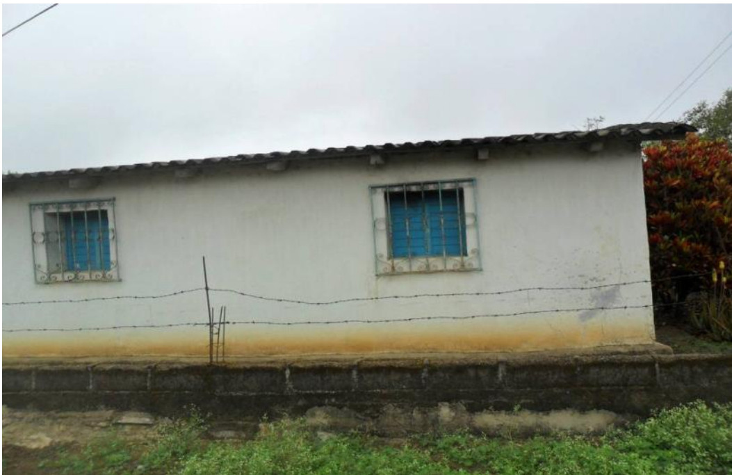
Foto 6.20 Localidad: La Florida. Vivienda de adobe con murete de tabique, para evitar que se afecte con las inundaciones.
