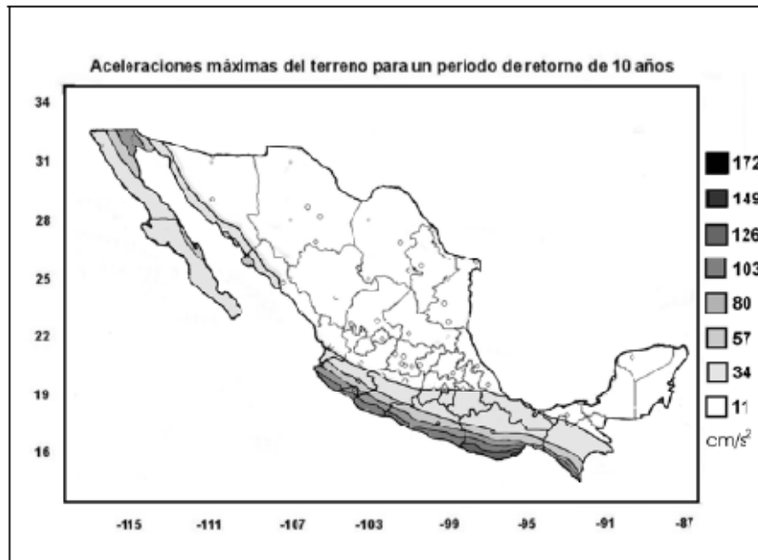
Figura. 23 Valores de aceleración máxima del terreno para periodo de retorno de 10 años. Fuente: CENAPRED.
