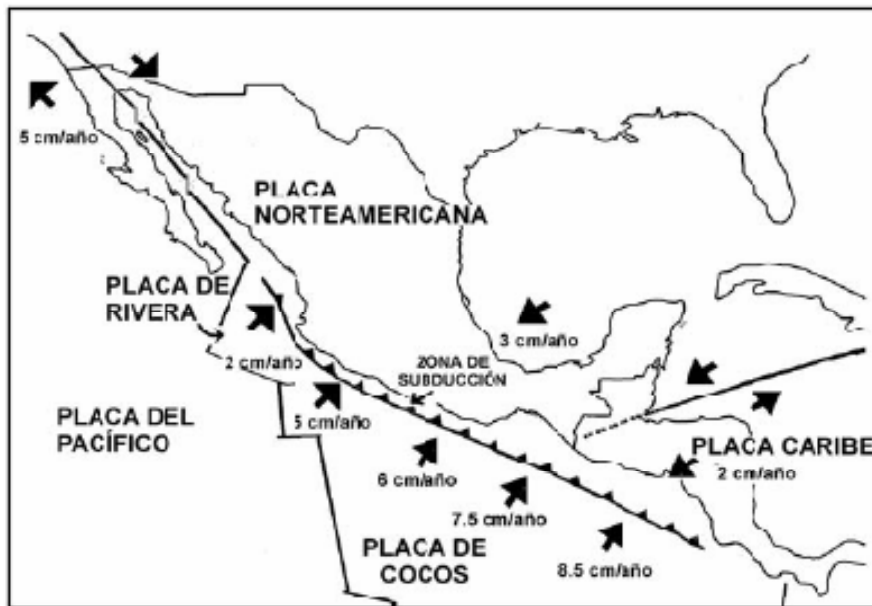
Figura. 22 Placas tectónicas y sus velocidades relativas promedio
