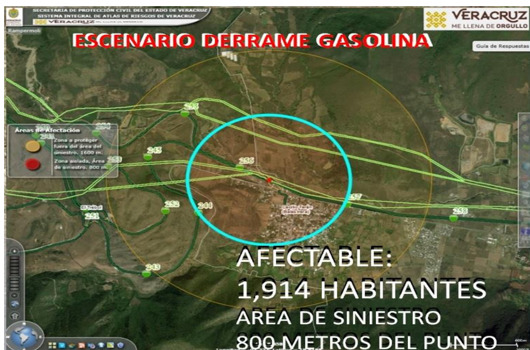
Figura 11.1.1.6 Escenario de riesgo realizado en el Sistema Integral de Atlas de Riesgos de Veracruz (SIAVER). Localmente muestra el área de afectación en uno de los cruces que atraviesan el río Chiquito.
