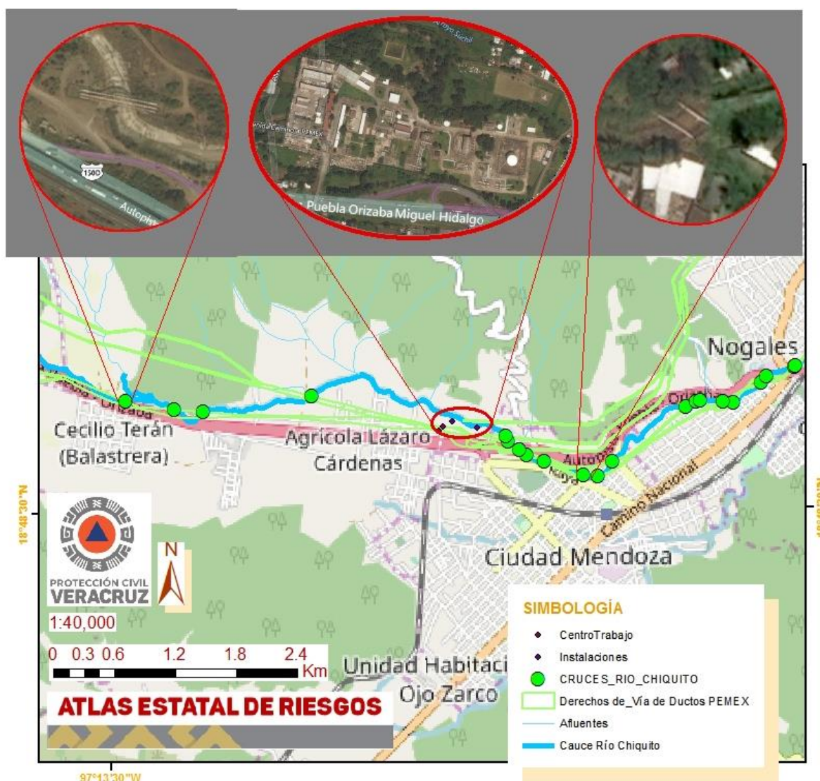
Figura 11.1.1.4 26 Cruces de ductos con el Río Chiquito de los cuales 4 están en Maltrata, 14 en Nogales y 8 en Camerino Z. Mendoza
