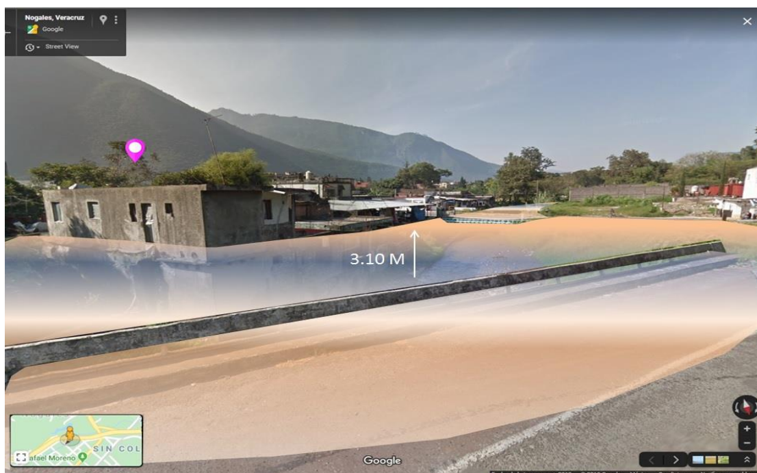
Figura 11.1.1.5 Puente vehicular administrado por CAFUPE. Ante taponamiento por arrastre de sedimentos, rocas y material de desecho, el nivel del cauce afecta a viviendas asentadas en las márgenes del Río Chiquito con tirantes que alcanzan el segundo nivel.
