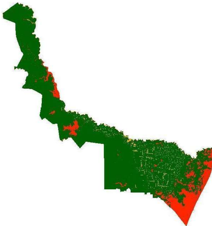
Imagen 5. Capa ponderada de los modelos hidrológicos de inundación recuperado del Atlas de riesgo del estado de Tamaulipas
