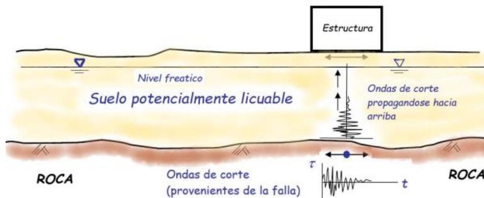
Figura 58. Esquema mostrando la generación del fenómeno de licuación sísmica. Fuente: (Pando, 2020)
