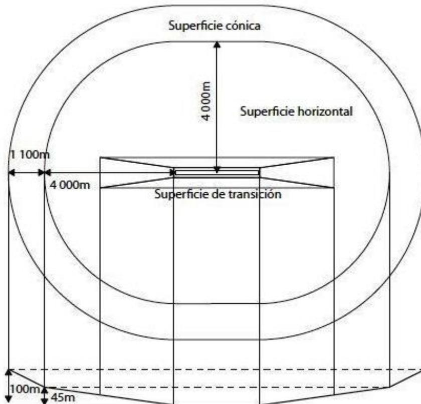
Figura 116. Vista en planta y de perfil de las superficies de transición, horizontal interna y cónica. Fuente: UNAM.
