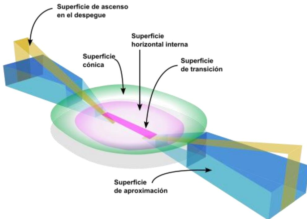
Figura 114. Superficies limitadoras de obstáculos consideradas para la elaboración de los mapas de aeródromo y de obstáculos de aeródromo. Fuente: UNAM.
