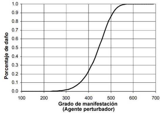
Figura 43. Función de vulnerabilidad para elemento con falla dúctil. Fuente: CENAPRED
