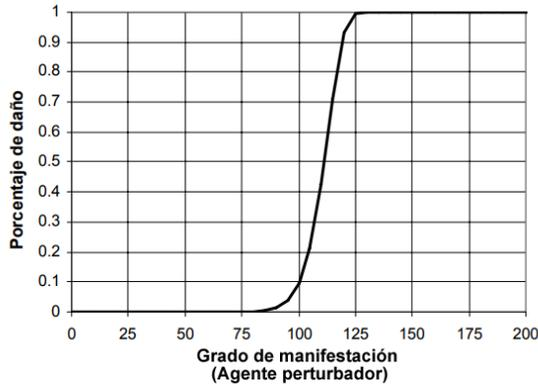
Figura 42. Función de vulnerabilidad para elemento con falla frágil. Fuente: CENAPRED
