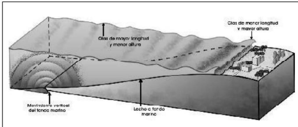
Figura 64. Generación, propagación y arribo a la costa de un tsunami. Fuente: (Fascículo "Tsunami", 2005).
