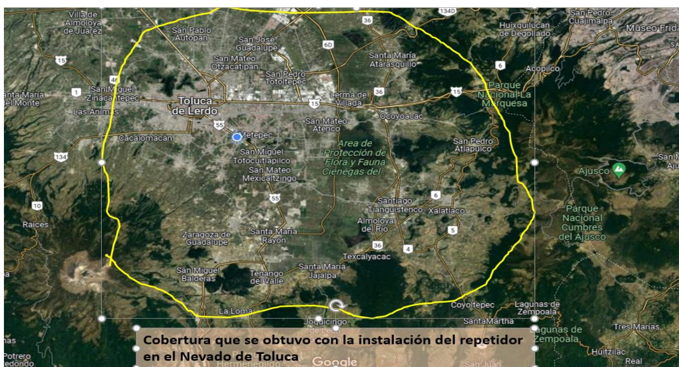
Imagen 98: Cobertura del repetidos de radio.
