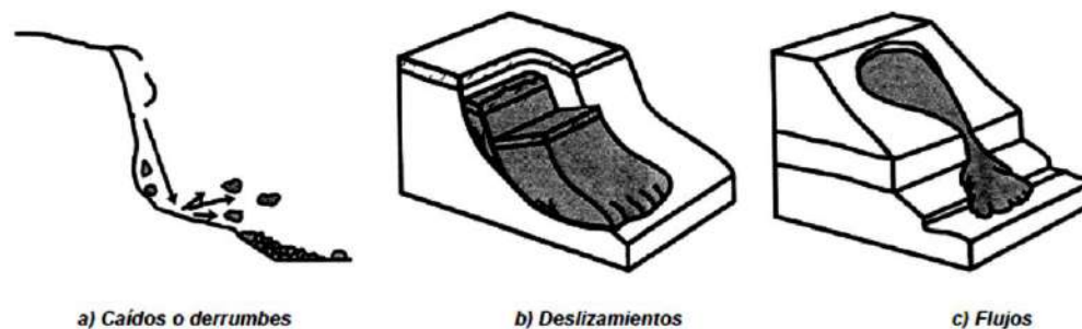
Fig. 5.1.4.1 Principales tipos de deslizamiento
