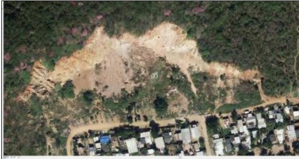
**Fotografía II.2.29.** Fotografía aérea tomada durante el presente estudio, en la cual se nota la cercanía de la colonia Felipe Ángeles y la serie de deslizamientos que ha sufrido el talud del sitio de la excavación, por los depósitos de fragmentos al pie de corte y la forma de abanico aluvial producto de los escurrimientos.
