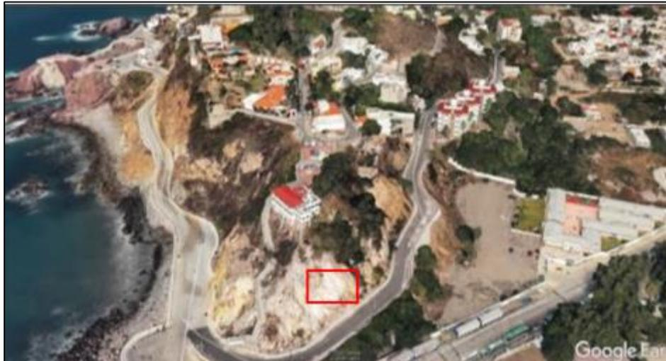
**fotografía II.2.07.** Imagen de la zona de estudio, que corresponde a la unidad geológica TePA conformada por andesitas y tobas andesíticas, las que observan un alto grado de alteración por metamorfismo de contacto e intrusión de una serie de diques de composición aplítica y andesítica. **Fuente.** Elaboración propia.
