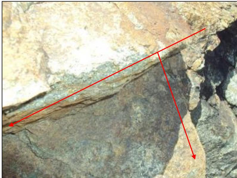
**Fotografía II.2.03.** Acercamiento fotográfico para observar el tipo de roca de composición andesítica, en la cual se observa una matriz color verdoso y minerales de plagioclasa, así como dos sistemas de fracturas perpendiculares entre sí. **Fuente.** Elaboración propia.
