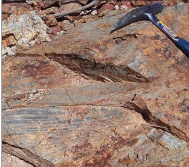
**Fotografía II.2.27.** Fotografía del afloramiento de esquistos que afloran en el cerro de la Colonia Felipe Ángeles; el fracturamiento que se observa tiene una dirección NW-SE, lo que genera bloques pequeños a medianos. **Fuente.** Elaboración propia.
