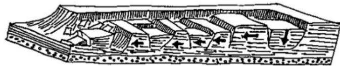
Figura d. Esquema de rotura progresiva con deslizamiento lateral.
