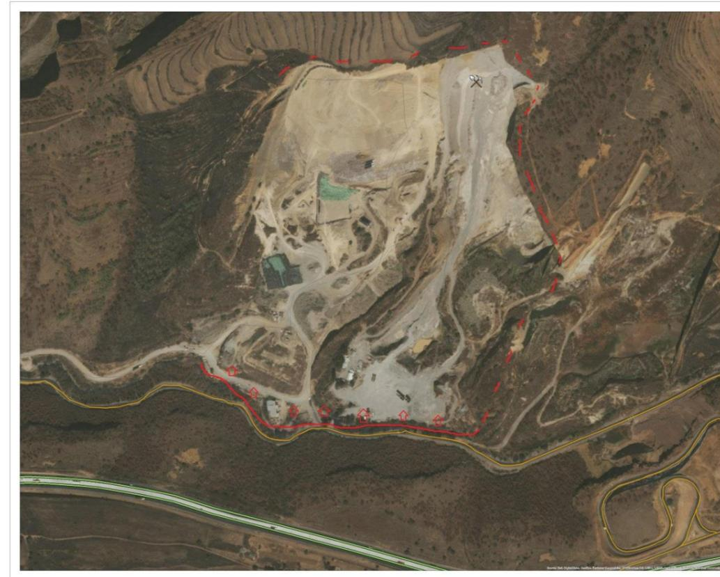
Al sur de la mina se aprecia la carretera México – Puebla. En la línea roja se aprecia la dirección de la caída o deslizamiento de material.
