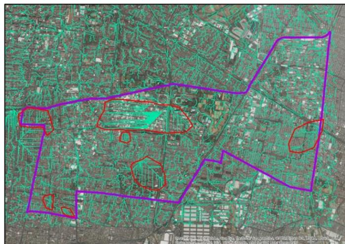
Figura 135. Red de flujos derivados de información LIDAR.
