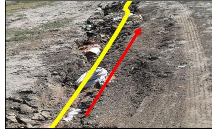
**Figura 89. Grieta por disecación del terreno en la localidad de ampliación Santa Cecilia**
