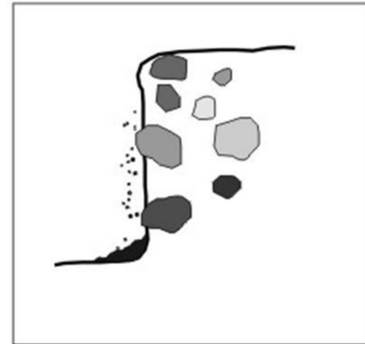
Figura 5.1.6.1. Ejemplo de una caída por desprendimiento de un bloque inmerso en una matriz arenosa.
