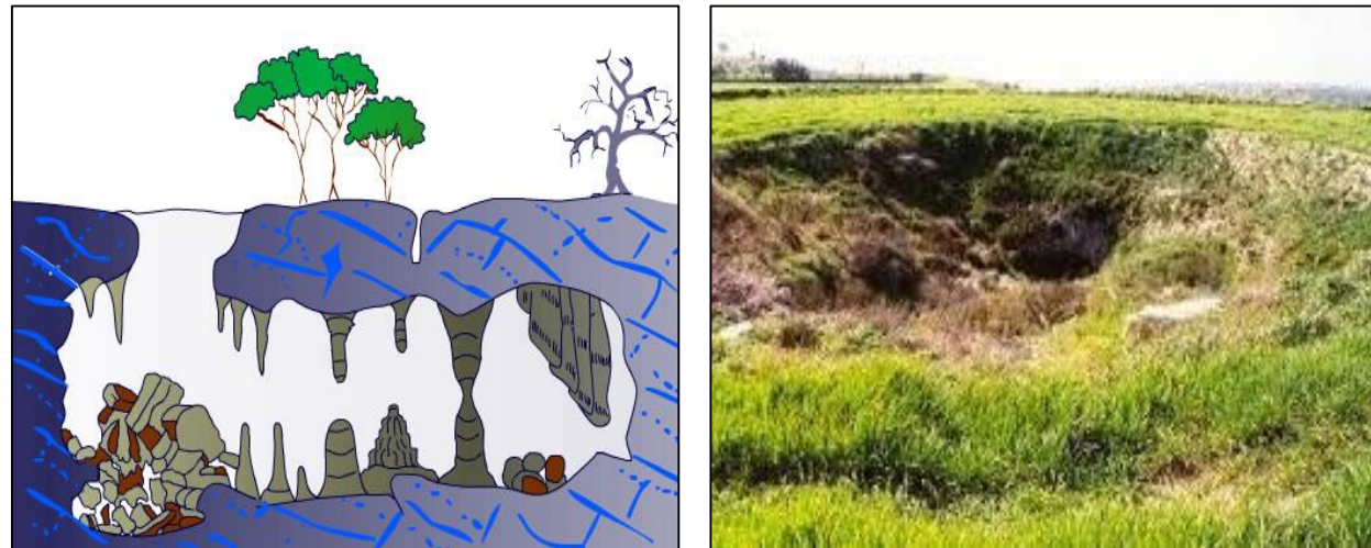
Figura 5.1.7.1. a) Izquierda. Representación del proceso de hundimiento en materiales carbonatados; b) Derecha. Hundimiento de materiales carbonatados.
