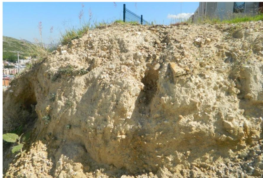
Fig. 20. Acercamiento del sustrato observado en El Rosario. Material reabajado, que al secarse tiene a compactarse y desarrollar grietas de menor extensión.
