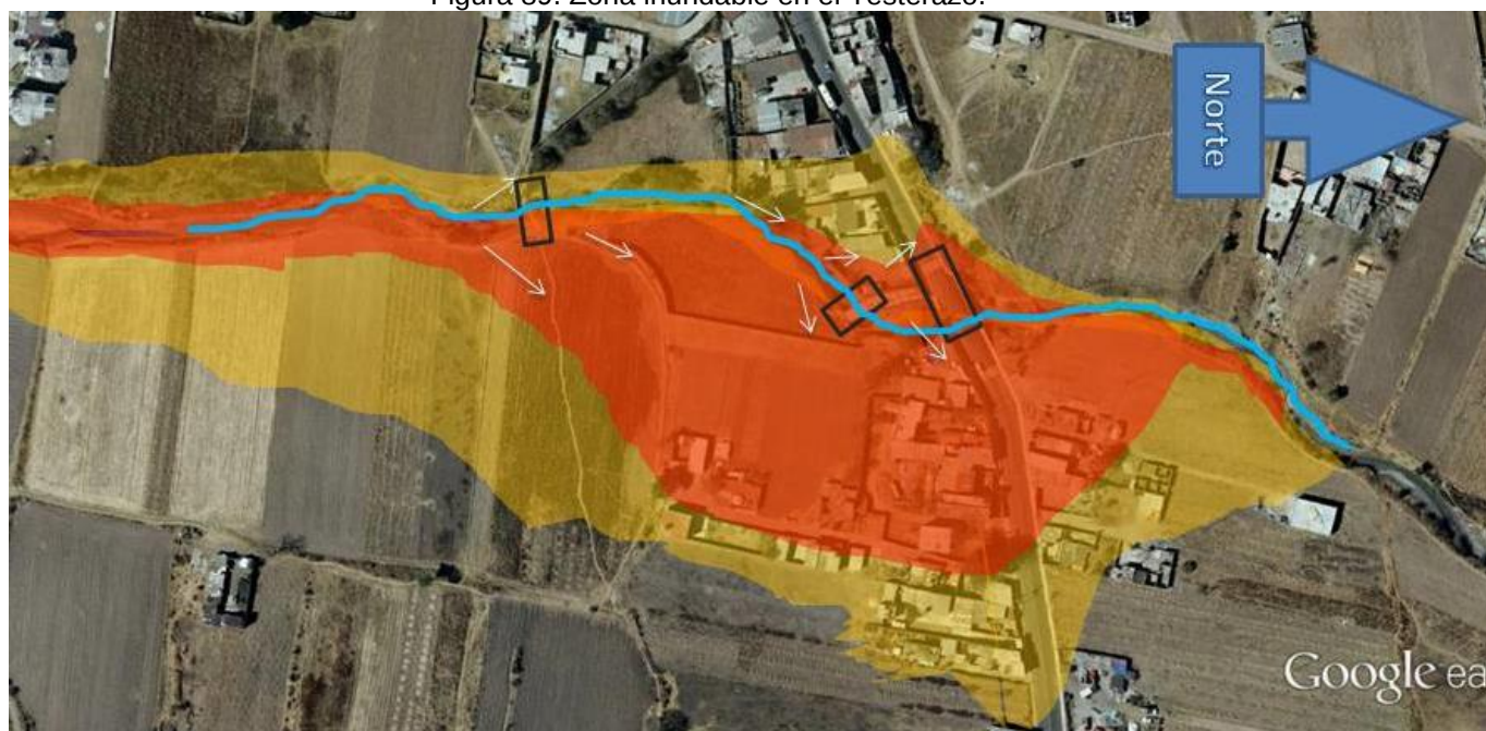
Figura 89. Zona inundable en el Testerozo.
