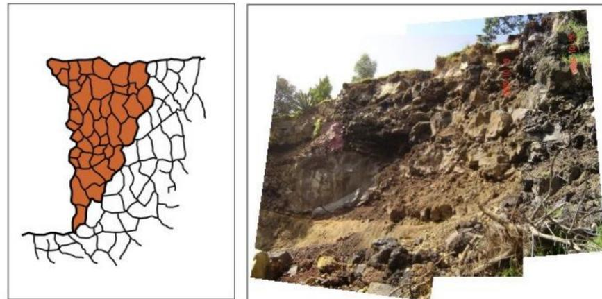
**Figura 5.1.4.16.- Aspecto de un mecanismo complejo, con una superficie de falla irregular.**
