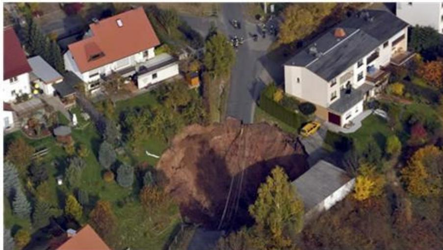
**Figura 5.5.2** Hundimiento de tierra de 40 metros de largo, 15 de ancho y 25 de profundidad. Se registró la madrugada del 1 de noviembre de 2010, en Turingia, al este de Alemania. La presencia de antiguas minas de sal durante la Edad Media, podría representar la causa del hundimiento.
