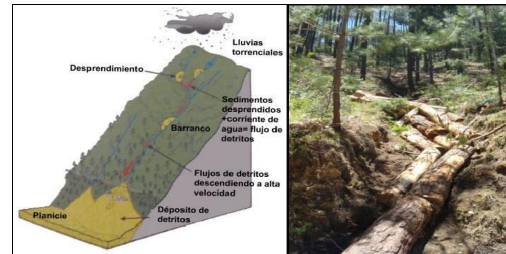
Ilustración 50. Esquema de cómo se origina un flujo de detritos. Derecha: flujo de detritos, localizado al Sur del Municipio.
