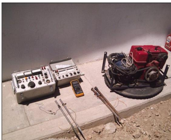
Foto No. 16.- Muestra el equipo SCINTREX empleado en el presente estudio (Aparato TRANSMISOR a la izquierda, aparato RECEPTOR al centro y MOTOGENERADOR a la derecha).
