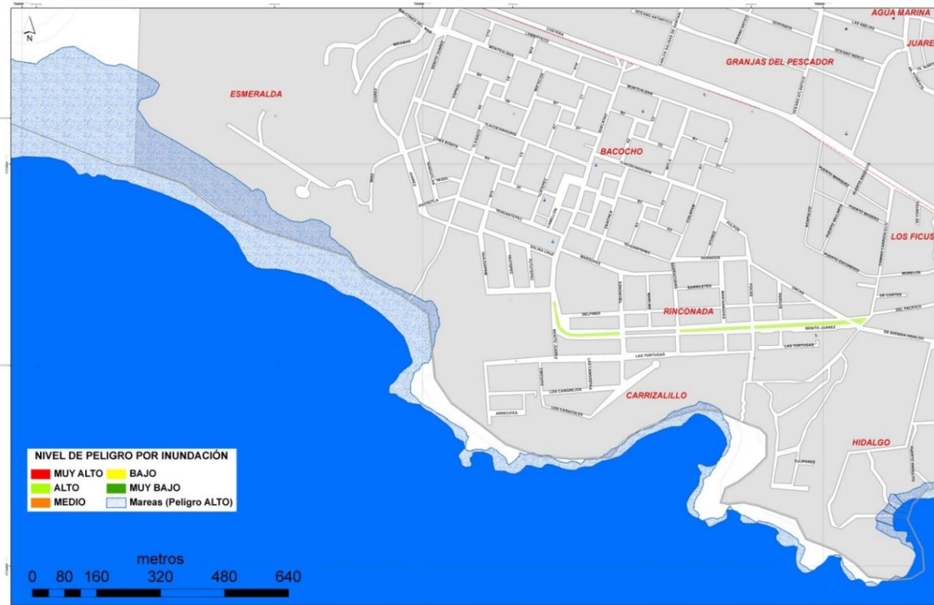
Figura 49. Inundaciones fluviales y por mareas en el malecón de Puerto Escondido (parte oeste).
