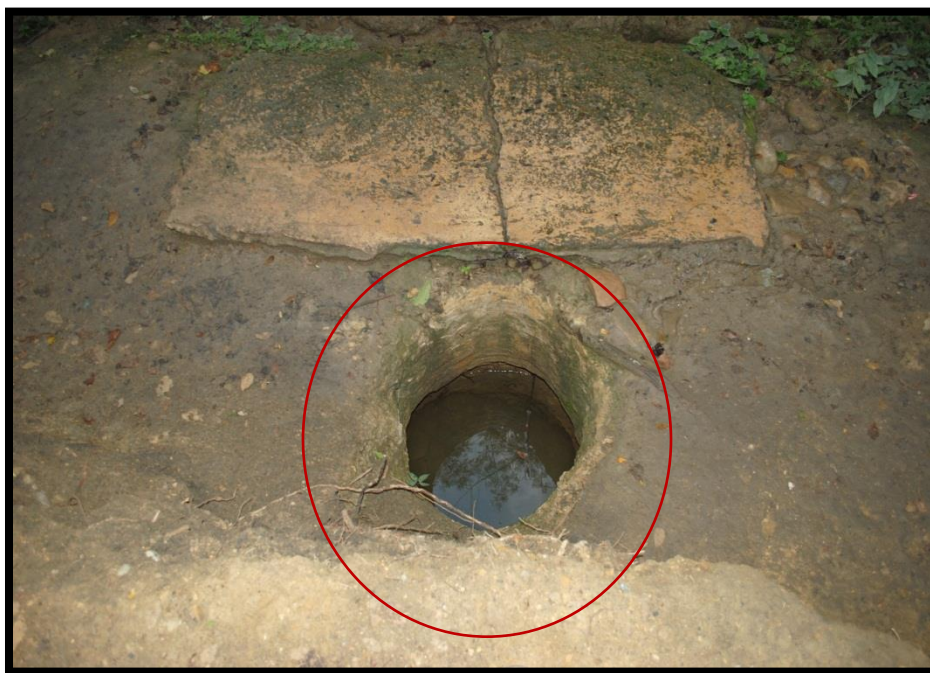
Figura 16. Presencia de hundimientos. Mantos acuíferos a 2 metros de profundidad, localidad Los Manantiales.
