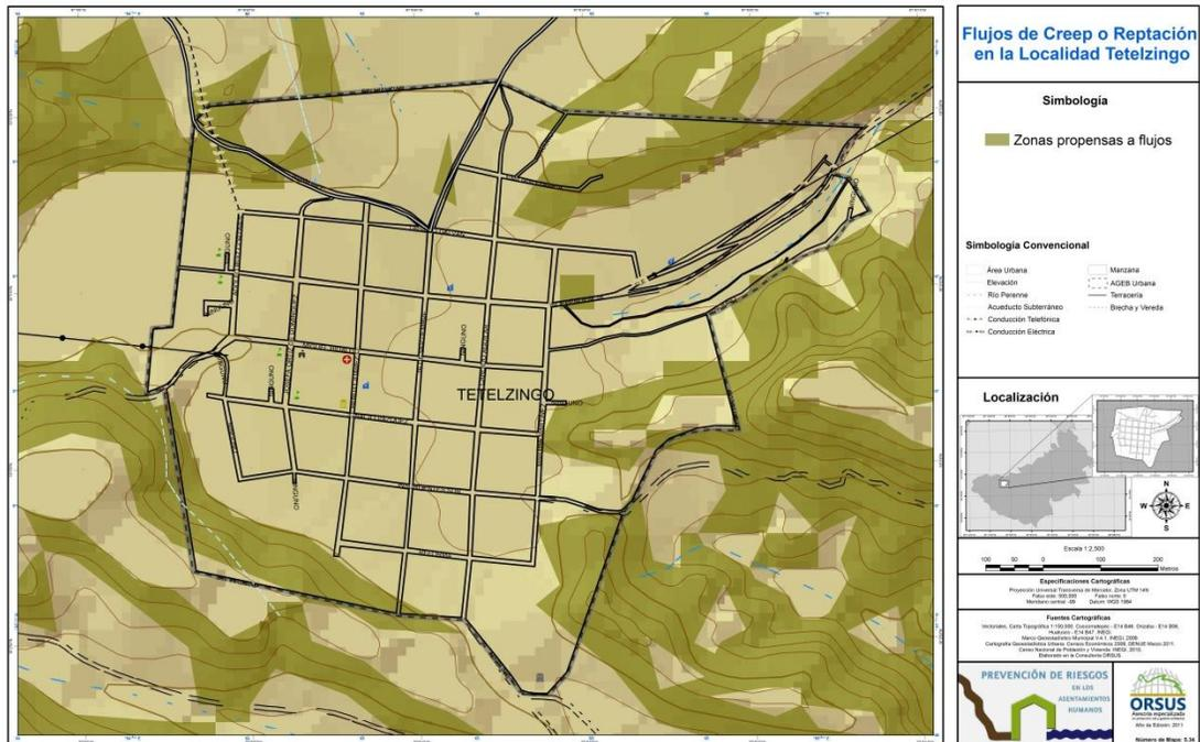
Figura 5.34. Zonas Propensas a Flujos de Creep para la Localidad Urbana de Tetelzingo, Coscomatepec.
