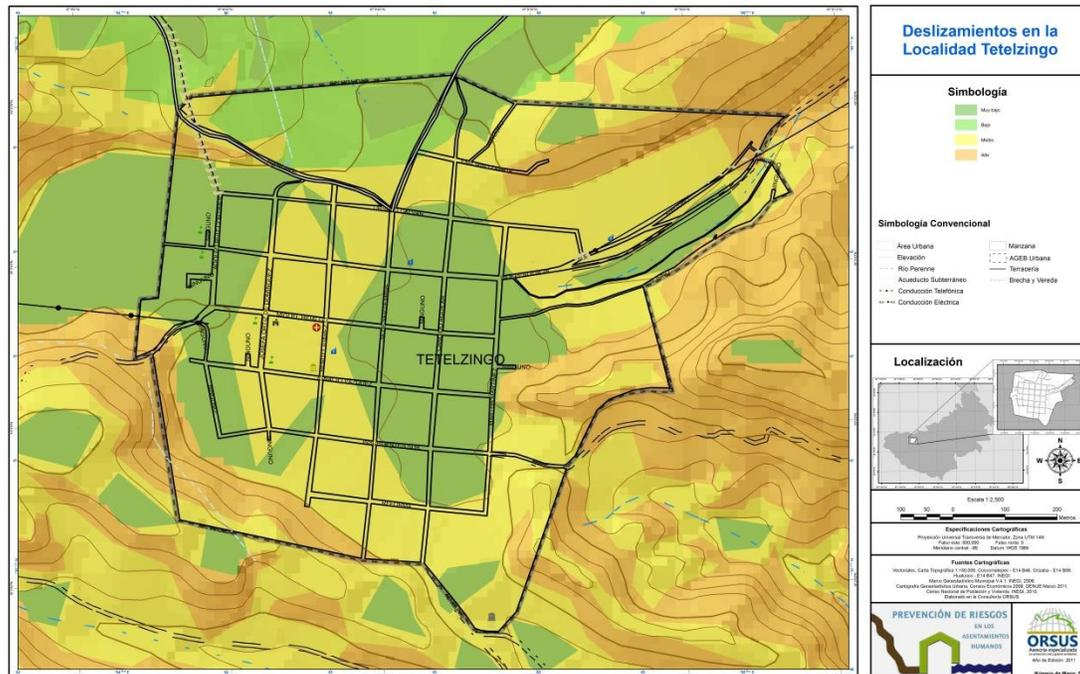
Figura 5.21. Riesgo por Deslizamiento II para la Localidad Urbana de Tetelzingo, Coscomatepec.
