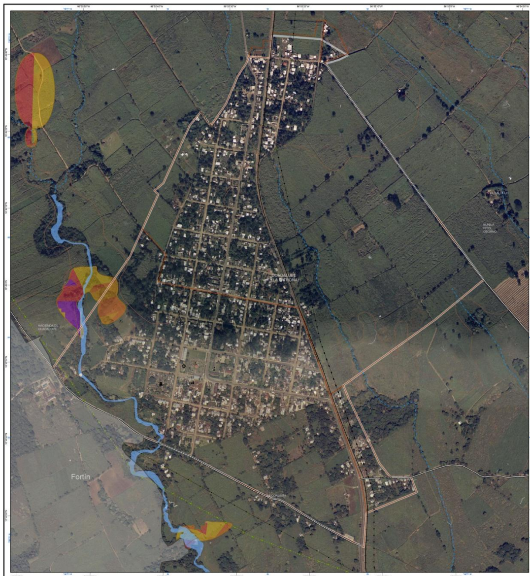
Figura 5.17a. Zonas Propensas a Flujos de Lodo, Tierra y Suelo para la Localidad Urbana de Amatlán de los Reyes, Amatlán de los Reyes.
