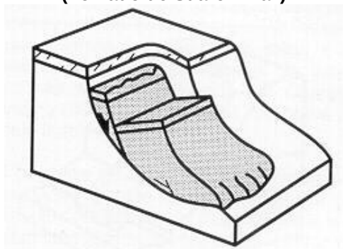
Imagen No 2.- Forma típica de un deslizamiento de tipo rotacional. (Tomado de Suárez-Díaz)
