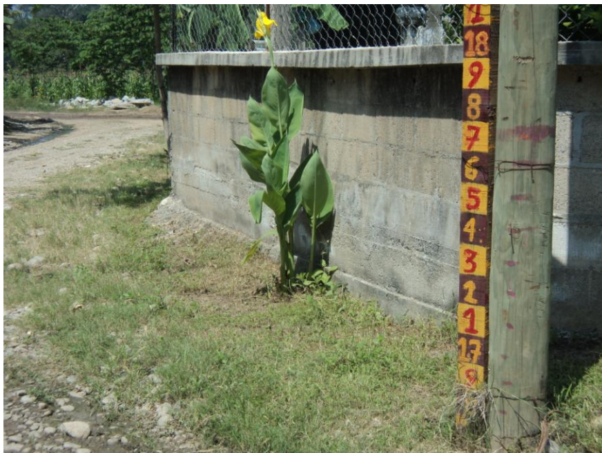
Fotografía No. 7. Escala crítica instalada por Protección Civil Municipal con el objetivo de monitorear el incremento del nivel del río.
