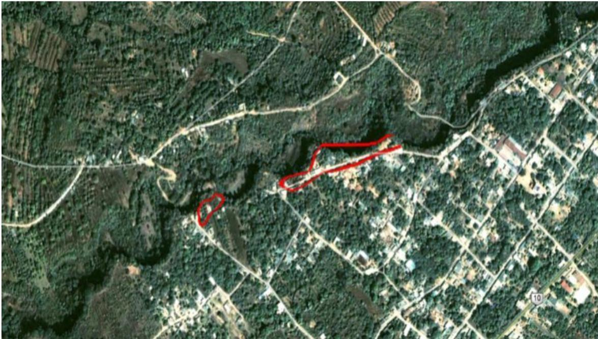
**Camino a Huecahuasco:** Derrumbes de depósitos de aluvión altamente intemperizado, cuyo grosor supera los 10 metros, en laderas con pendientes superiores a los 60°. Los cortes de carretera y la respectiva continuidad del depósito de aluvión ha provocado que la carretera tenga agrietamientos y colapsos en sus orillas debido a la remoción de los materiales sobre los cuales se encuentra construida.
