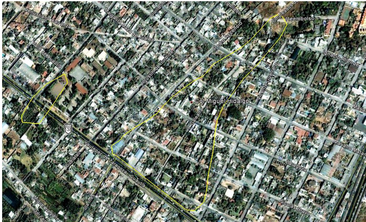
Figura 46. Zona de inundación en colonia Miguel Hidalgo. La carretera funge como bordo de inundación.
