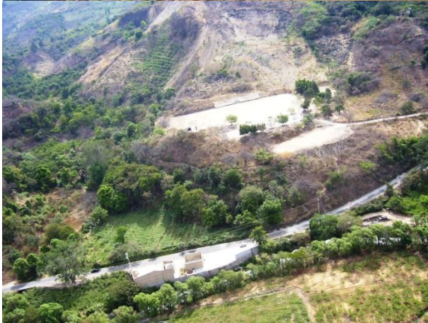
Ilustración 15.- Deslizamiento en ladera, de tipo rotacional en rocas.
