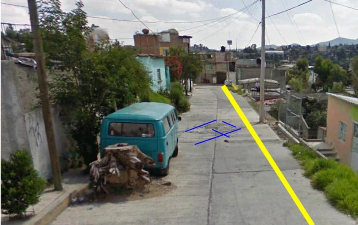
Figura 5.4. Expresión de una fractura geológica (línea amarilla) sobre la calle Venustiano Carranza, se observan grietas en el pavimento de la calle (líneas azules).
