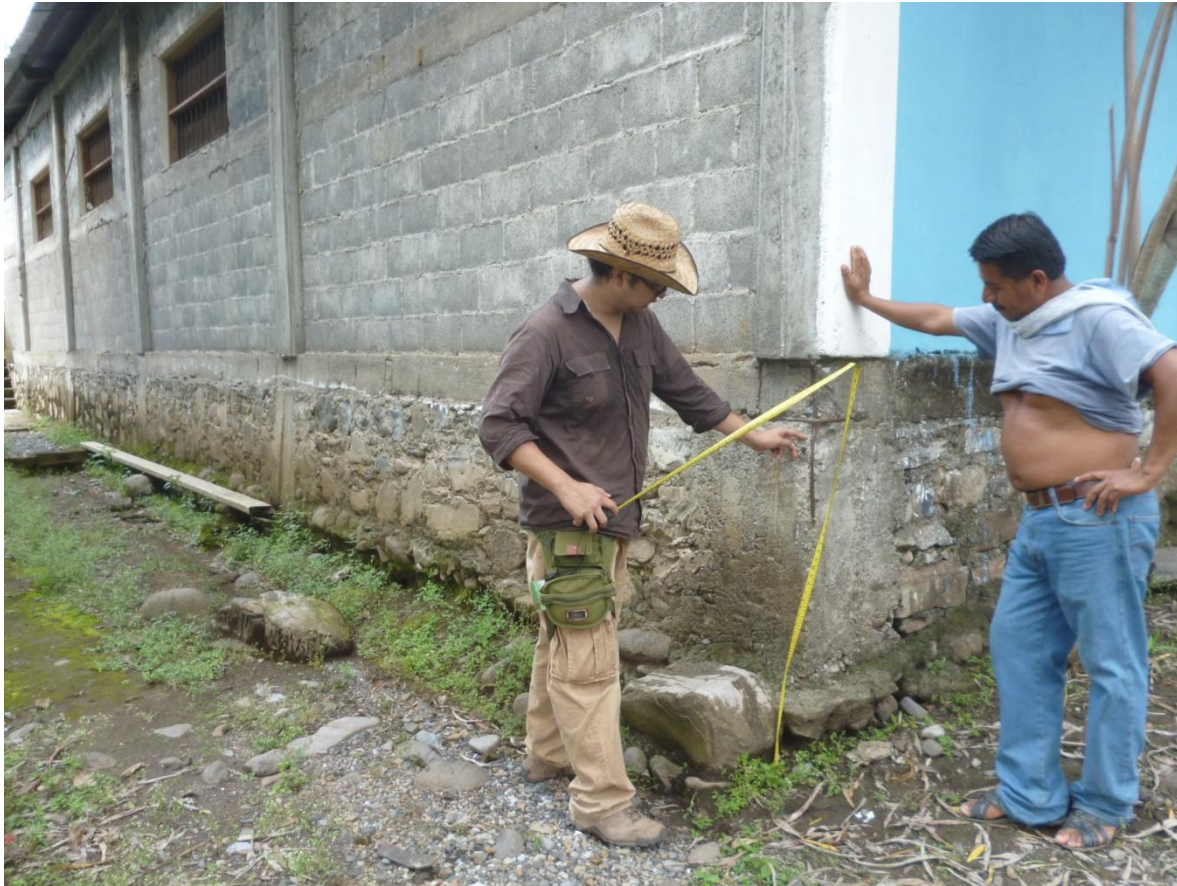
Fotografía 1. Medición del tirante de inundación localidad de Peyula, Tlanchinol Hidalgo.
