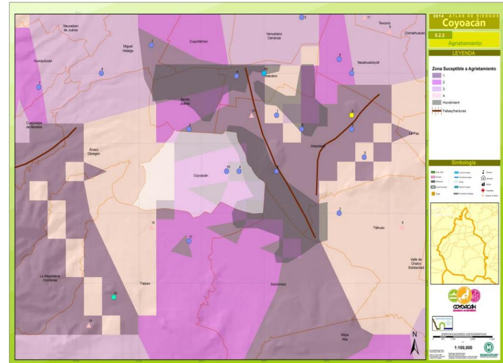
Ilustración 70. Zona susceptible a agrietamientos
