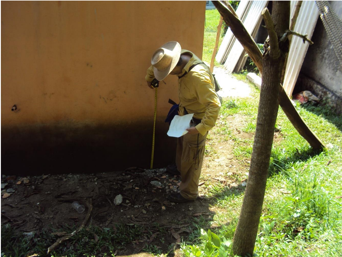
Ilustración 12. Toma del tirante de la inundación. Municipio de Ángel R. Cabada, Veracruz.
