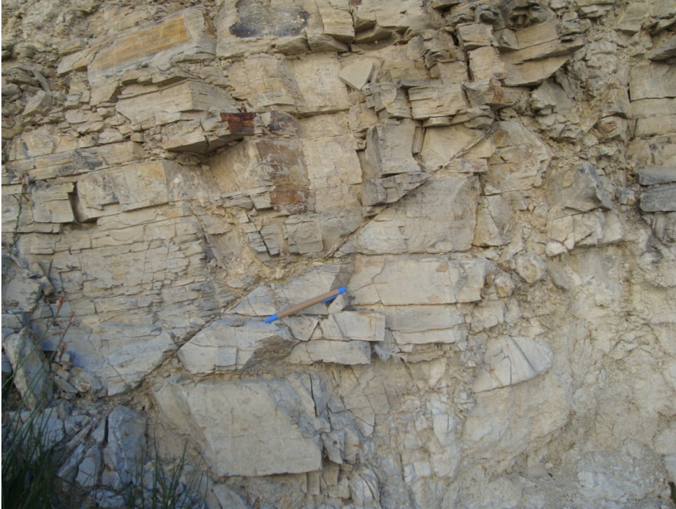
Figura RG-02.- Lutitas fracturadas e intemperizadas con un grado de susceptibilidad alto a los derrumbes y deslizamientos. (reporte fotográfico de campo)
