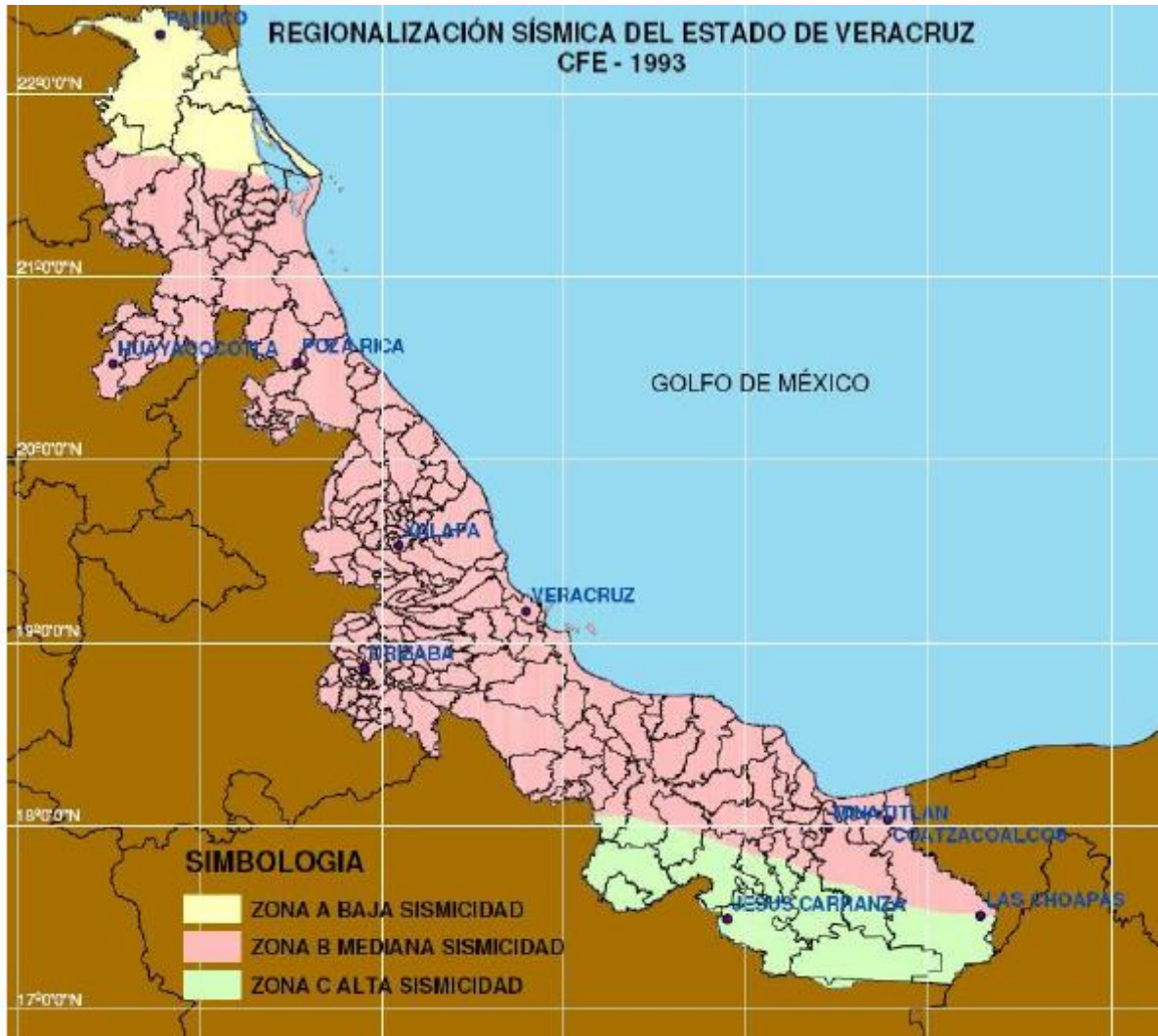
Figura E5. Regionalización Sísmica CFE, 1993.
