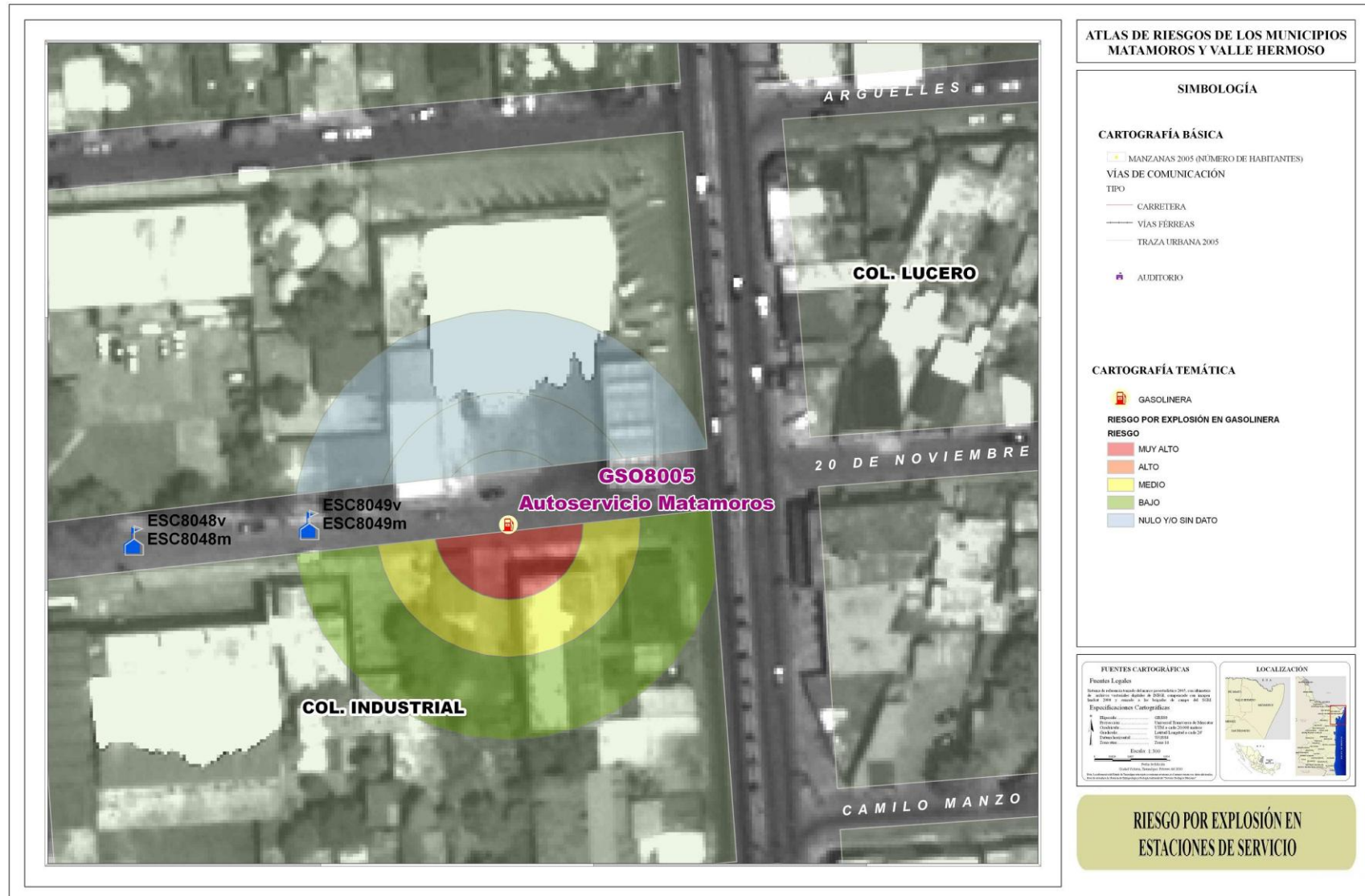
Figura 62. Riesgo por explosión de la gasolinera Autoservicio Matamoros.
