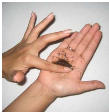
Fotografía 4. Método de la Consistencia cerca del límite plástico.
