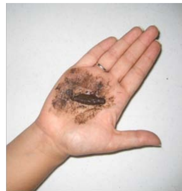
Fotografía 4. Método de la Consistencia cerca del límite plástico.
