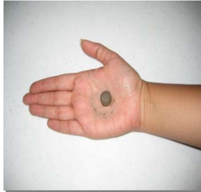
Fotografía 5. Método de Dilatancia.
